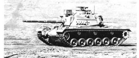
Um eine Kampfkraftsteigerung bei den veralteten amerikanischen M-48-Panzern der deutschen Bundeswehr zu erreichen, werden diese mit einer 105-mm-Kanone ausgerüstet.
