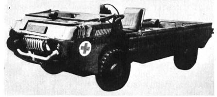
Im Automobilwerk Lugansk wurde für die Sowjetarmee der LuAS 967 M entwickelt. Er dient dem Verwundetentransport vom Gefechtsfeld. Das Fahrzeug entstand auf der Basis des sowjetischen Kleinwagens Saporeshez. Es hat Allradantrieb und ist schwimmfähig. Seine Höchstgeschwindigkeit auf der Strasse liegt bei 75 km/h, auf dem Wasser 5 bis 6 km/h. Der Wasserantrieb erfolgt über die Räder. Der Wagen kann vier Verwundete transportieren, zwei auf Tragen, zwei weitere auf Klappsitzen.
