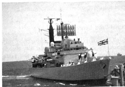
Der neue Raketenzerstörer «HMS Birmingham» folgte an der Flottenparade der königlichen Jacht «Britannia». Vorne sind die 11,4-cm-Kanone und der Zwillingsstarter für die See-Luft-Flugkörper des Typs Sea Dart zu erkennen. Auf diesem Schiff fuhr die versammelte Admiralität mit. Es fungierte als Flaggschiff der Parade.
