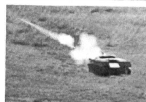
Abfeuern einer Raketengranate (425 m/s) und anschliessende Zündung des Raketenmotors (Beschleunigung auf 700 m/s)
