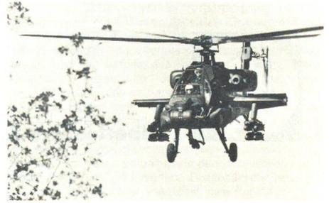
tionsrate von maximal 8 Einheiten, 1989 fertiggestellt werden. Zurzeit evaluiert auch das USMC den Advanced Attack Helicopter und verschiedene Überseeaaten, darunter die BRD, zeigen Interesse an diesem Tag- und Nachtkampf tauglichen Waffensystem. Unser Foto zeigt einen mit acht lasergesteuerten Hellfire Panzerabwehr- lenkwaffen bestückten AH-64 nach dem Pop Up in Schiessstellung. ka
