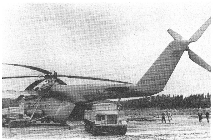
Der Mi-6 (HOOK) fasst bis zu 65 ausgerüstete Soldaten oder kann Materialtransporte bis zu einer Nutzmasse von 12000 kg durchführen.
