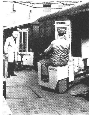
SIG-LIFTER Elektro-Pratzenstapler mit Quersitz- oder Deichsellenkung
