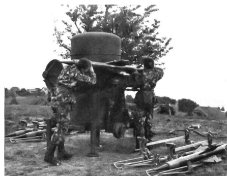
Beladung der RAPIER-Lenkwafe durch zwei Mann ohne mechanische Hilfe.
