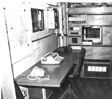
Im Einsatz stand auch diese mobile Einsatzzentrale. Der in eigener Regie um- und ausgebaute geländegängige Sanitäts-Mowag – ausgerüstet mit Notstromaggregat, Lichtmast, Funk mit Zerhacker, Tonbandgerät, Schreibmaschine, Vervielfältigungsapparat, Kartenmaterial usw – hat sich als KP-Front bereits in mehreren Einsätzen bestens bewährt.
