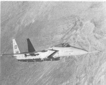
An ihrem rumpfkongruenten Brennstoffzusatzbehälter führt diese F-15 Eagle an kleinen Stummelträgern insgesamt 12 x 227 kg Mehrzweckbomben Mk82 mit. Diese widerstandsarme Aufhängart vergrössert den
