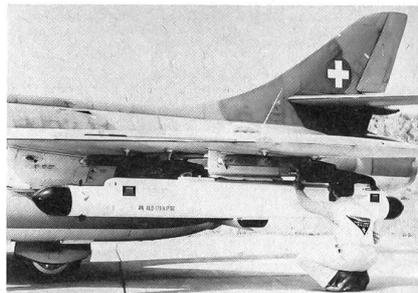
Mit der Behälterversion des Selbstschutz-Störsenders AN/ALQ-171(V) von Northrop fanden Tragversuche an Bord eines Hunters der Schweizer Flugwaffe statt. Für die Energieversorgung des Mehrbetriebsarten-Störsenders ist im Rumpfbug der Gondel eine Stau-luftturbine integriert. Bekanntlich beteiligt sich die Schweiz an der Entwicklung der u. a. für die Ausrüstung der F-5E/F Tiger bestimmten rumpfkongruen Ausführung des Systems AN/ALQ-171(V). ka
