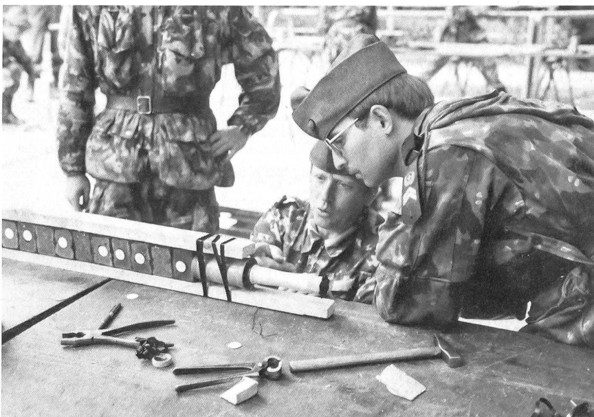
Herstellung einer gestreckten Ladung
