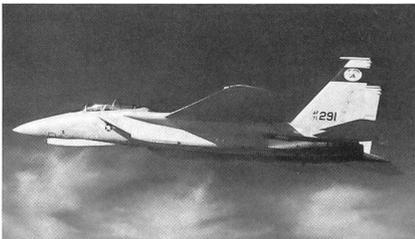
Zurzeit erprobt McDonnell Douglas eine F-15B Eagle, die mit einem besonderen Behälter im Bereiche des Rumpfes unter dem Cockpit ausgerüstet ist. Der entsprechende Pod ist so ausgelegt, dass er eine Vielzahl von Sensoren aufnehmen könnte, wie sie zB von Aufklärungs- und Radarbekämpfungsflyzeugen mitgeführt werden. ka
