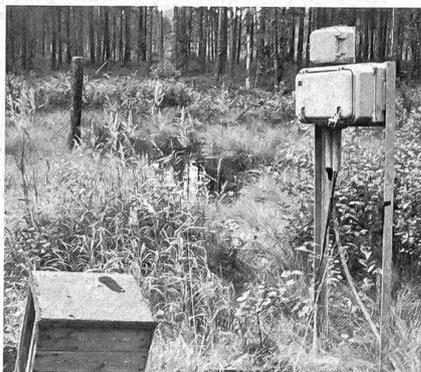
Zum Seismologischen Observatorium gehören auch eine Anzahl aussenstehender Stationen wie beispielsweise diese Schaltdose für den kurzperiodischen Bohrloch-Erdbebenmesser.
