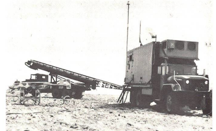
Scout Drone mit dazugehörigem Startkatapult im Hintergrund und Einsatzleitfahrzeug im Vordergrund. Links im Bild eine getarnte Scout Drone. Die Drone kann via Katapult als auch von herkömmlichen Start- und Landepisten gestartet werden.
