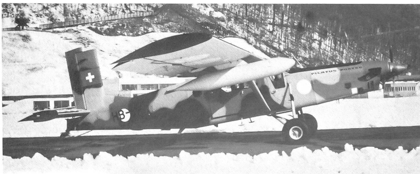
Pilatus PC-6/B2-H2 Turbo Porter auf dem Ablieferungsflug in den Nahen Osten. Unter dem Flügel erkennt man den 245 Liter fassenden Zusatztank, mit dem die Reichweite des Porters erheblich gesteigert werden kann. Der PC-6 kann an jedem Flügel insgesamt zwei Zusatztanks mitführen.
