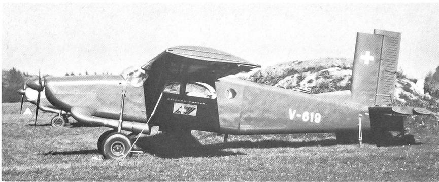
PC-6-H 2M Porter der Flugwaffe, ausgerüstet mit einem Kolbenmotor. 1980 wurden diese 12 Porter auf den Turbo-Porter-Standard gebracht.
