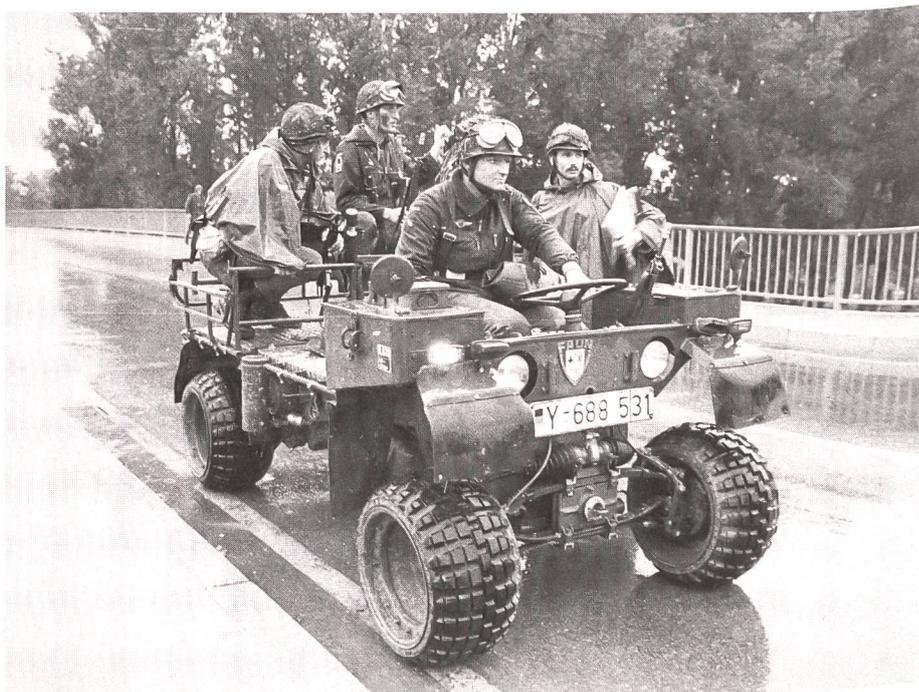
Fallschirmjäger auf dem Marsch mit ihrem «Kraka» (Kraftkarren), einem leichten, 0,75 t schweren, luftverlastbaren Fahrzeug
