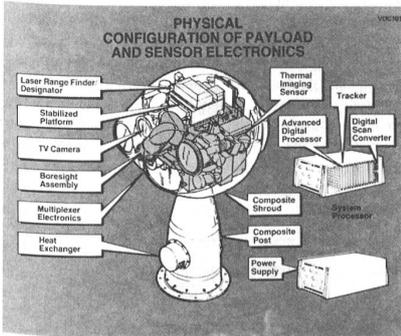
Die OH-58D-Advanced-Scout-Hubschrauber werden bei der US Army im Verbund mit dem Kampfhubschrauber AH-64A Apache zum Einsatz gelangen. U.a. für dieses Waffensystem wird der OH-58D Ziele suchen, vermessen und anschließend für den Einsatz von lasergesteuerter Munition ausleuchten. Dabei werden die vom Mastvisier berechneten Zielwerte automatisch an den AH-64A und/oder andere Bedarfsträger in der Luft und am Boden übermittelt.
