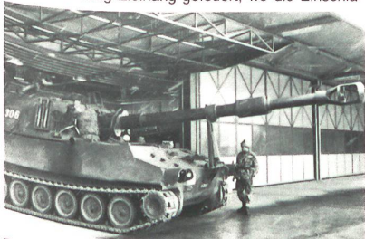
Eine Pz Hb einsatzbereit in der neuen Gesch Halle. Techn. Daten: Gef Gew 25,5 t, Leer Gew 22,8 t, Länge 9,05 m, Breite 3,18 m, Höhe 3,2 m, max Schussdistanz 17 km, Besatzung 1 Kdt, 1 Fhr, 6 Kan.
