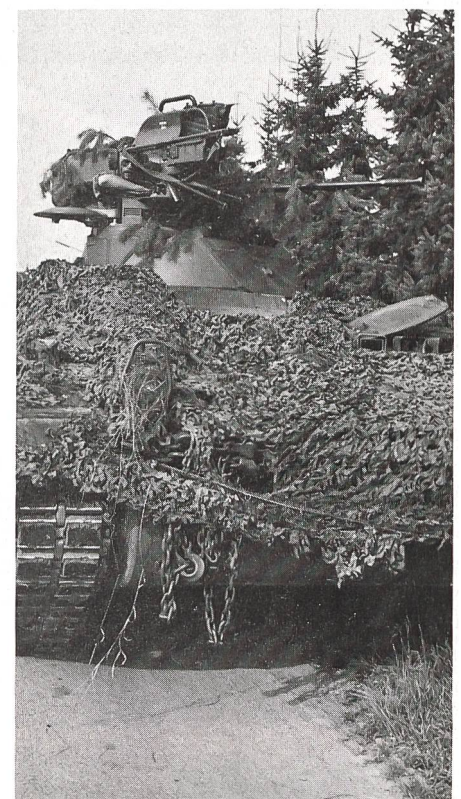
6 Schützenpanzer Marder mit Abschuss-Haltevorrichtung für die Panzerabwehrrakete Milan
