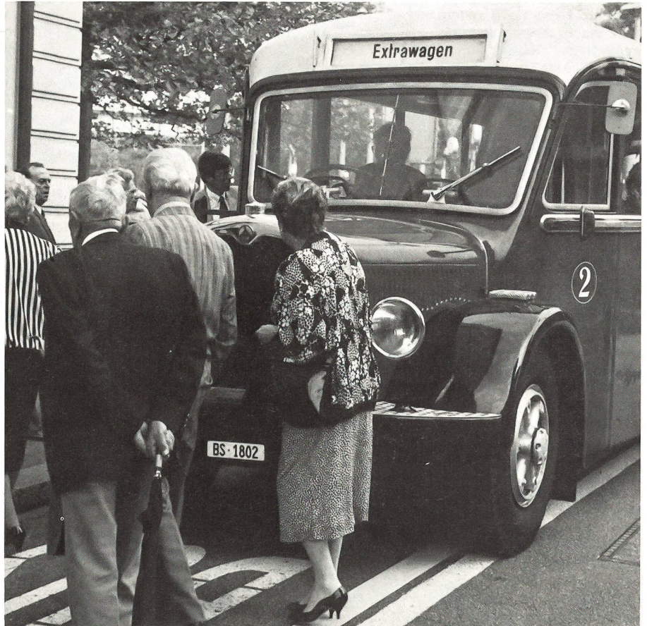
Wm Ernst Herzig organisierte die beeindruckende Rundfahrt durch die Rheinstadt Basel. Unser Bus der Verkehrsbetriebe Basel, mit Fahrer Kestenholz, Jahrgang 1930 und damals mit Benzinmotor, 1942 auf Holzgas umgebaut und 1947 mit einem Sechs-Zylinder-Dieselmotor ausgerüstet.
