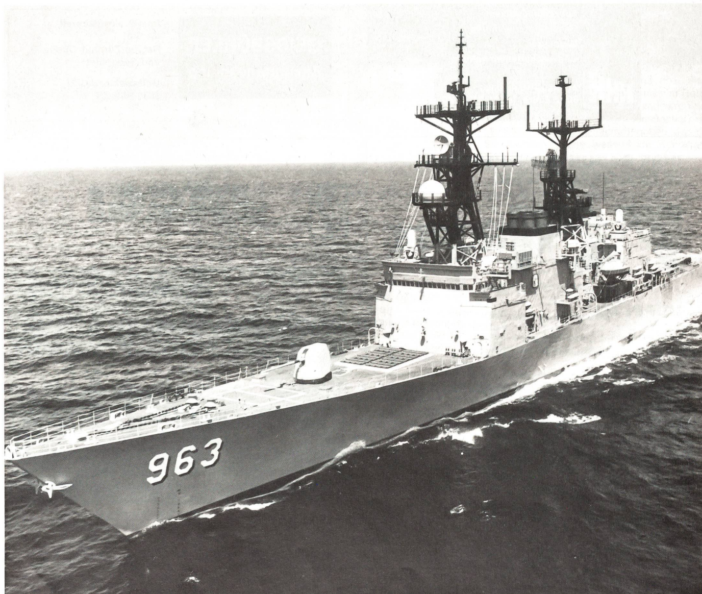
Die 24 Zerstörer der «Spruance»-Klasse (von insgesamt 31 Einheiten) werden im Rahmen von Routineüberholungsarbeiten anstelle der traditionellen Doppelstarter vorne und achtern ebenfalls mit dem im Rumpf versenkten VLS (Vertical Launch System) ausgestattet. Das Leitschiff «Spruance» (DD-963) hat diese Modernisierung als erste Einheit am 1. 6. 87 abgeschlossen. Die Schächte sind hinter dem Geschützturm gut zu erkennen. ■
