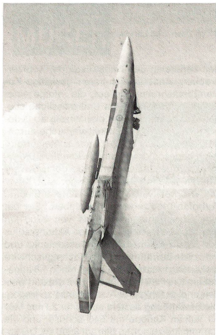
CF-18A, Hornet, der 1. Canadian Air Group. Zu beachten ist das aufgemalte Cockpit an der Rumpfunterseite, das im Luftkampf den Gegner täuschen soll.
