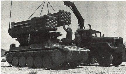
dige Aufmunitionierung ist in 10 Minuten zu bewältigen. Durch das Schiessen einer ersten Pilotrakete können mit dem Contraves Feuerleit- und Kontrollgerät die für ein Ziel notwendigen Wirkungselemente ermittelt werden. Ho
