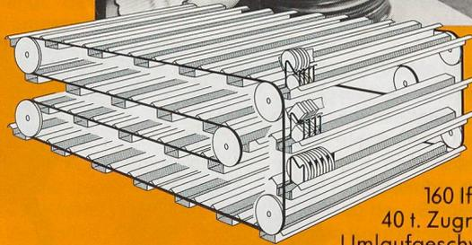
5000-10'000 Filmspulen und Videokassetten der Armee lagern in 40 Gondeln zu je 4,0 m Länge = Gesamtlänge 160 lfm. Totales Nutzgewicht 40 t. Zugriff: Ø 15-20" bei ca. 15m/ Umlaufgeschwindigkeit. Ausmasse: H 2,5 m – T 7,0 m – B 4,8 m.
