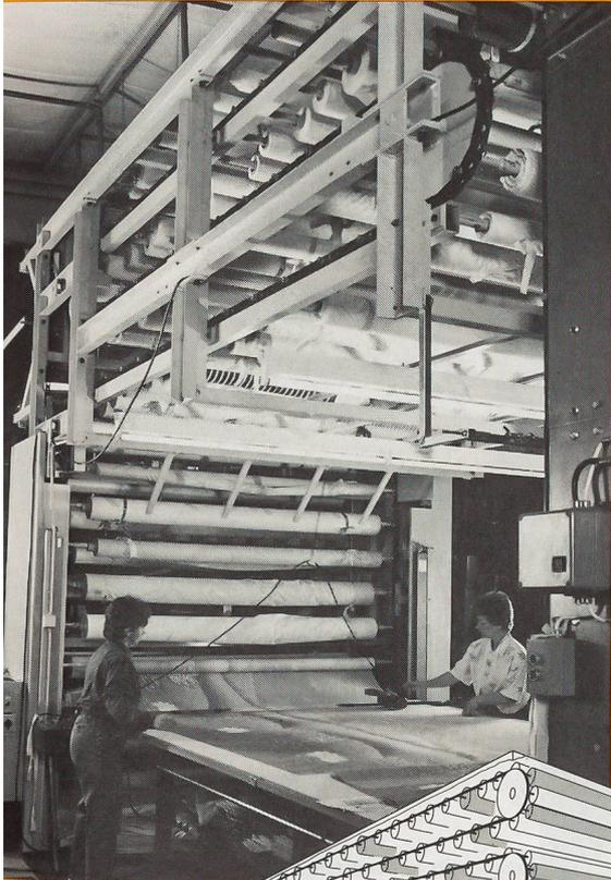
Über 100 Rollen Stoff in unterschiedlichsten Dessins lagern hier direkt neben und über dem Arbeitsplatz: Superschneller Zugriff! Ausmasse: H 4,2 m – L 5,9 m – B 2,8 m. Gesamtzuladung: 5 t.
