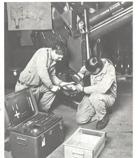
Zwei Geschmechaniker der Mob Artillerie beim Auswechseln der Bremsbacken eines Geschützes.
