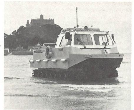
Wüstensand und sogar Schwimmsand. Dabei erreicht es auf Strassen Geschwindigkeiten bis 50 km/h.
