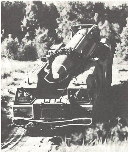
operativ-taktische Rakete SCUD-B der UdSSR (Reichweite 280/300 km, nuklearer, konventioneller oder chemischer Gefechtskopf)
