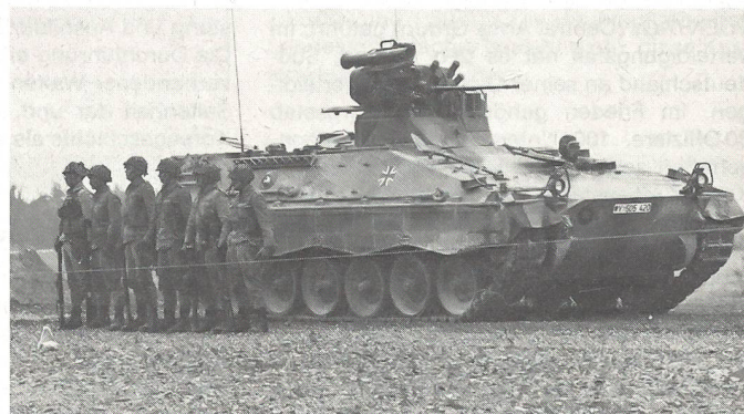
Die Besatzung dieses Schützenpanzers des Typs «Marder» präsentiert sich den Zuschauern. Gut sichtbar die Abschussvorrichtung für die Panzerabwehrrakete «Milan».
