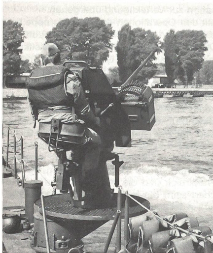
Zwei Geschütze befinden sich auf der Pionierfähre BODAN. Die BMK 20 mm (Bordmaschinenkanone). Es sind zwei Kisten mit 75 Schuss Munition einsetzbar.
