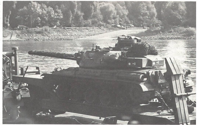
Der französische Tieflader (T12), welcher einen französischen Panzer AMX 30 B2 mit sich führt, ist auf die deutsche Pionierfähre BODAN aufgefahren.
