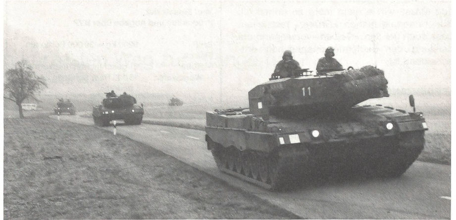
Die Pz Kp 1/12 auf dem Marsch. Kann ausserorts die mögliche Höchstgeschwindigkeit von 72 km/h bei günstigen Verhältnissen ausgefahren werden, so wird das Tempo innerorts stark gedrosselt. Die Besatzung besteht aus 4 Mann, die Hauptbewaffnung ist die 12 cm Pz Kan 87.
