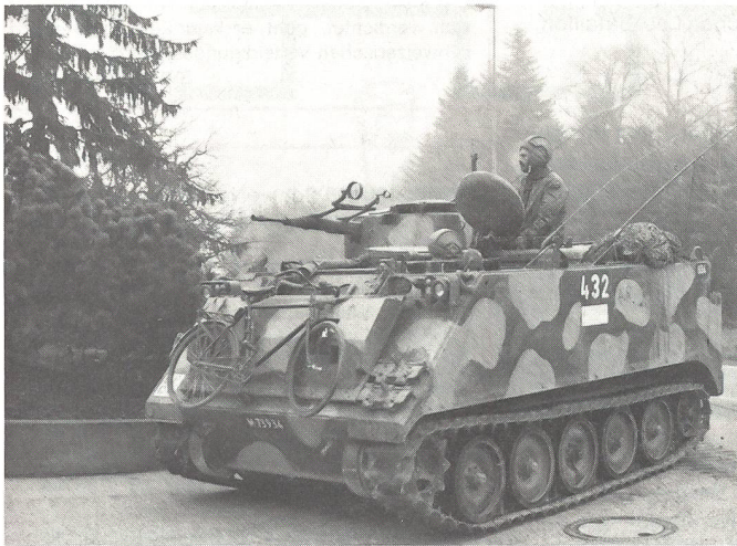
Wohl am wenigsten froren die sieben Panzergrenadiere, denn nach dem Verlassen ihrer Schützenpanzer 63/73 mangelt es ihnen nicht an Bewegung. Das Fahrzeug wiegt 11,5 t und ist mit einer 20 mm Maschinenkanone bewaffnet.
