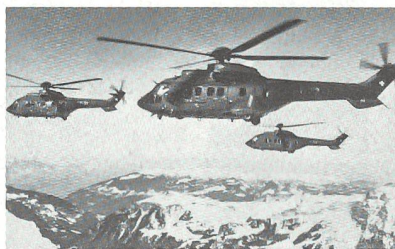
Die drei SUPER PUMA der Schweizer Armee im Flug. Deutlich ist das Hauptunterscheidungsmerkmal zum «normalen» PUMA zu erkennen – die zusätzliche Kieflösse unter dem Heckausleger.
