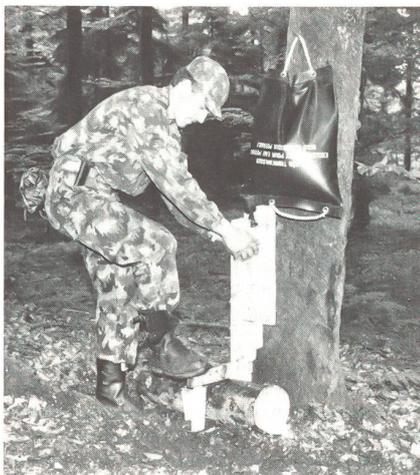
Gerade in einfachen Verhältnissen kommt der Hygiene ein besonderer Stellenwert zu. Die Handwascheinrichtung funktioniert per Fussdruck!
