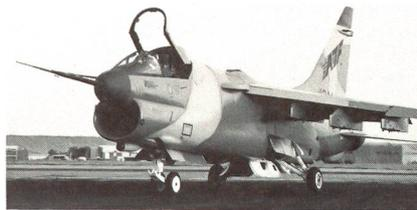
A-7F an sechs Unterflügel- und zwei Unterrumpfstationen bis zu 7,8 Tonnen Nutzlast, darunter praktisch alle im Inventar der US Air Force vorhandenen Luft/Boden-Waffen, mitführen können. LTV schlägt das Kampfwertsteigerungsprogramm A-7F für die Modernisierung der gesamten Flotte von mehr als 300 A-7D und A-7K Corsair II Apparate der US Air National Guard vor.
