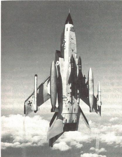
handelt es sich um einen Anti-Radar-Lenkflugkörper, während die «Kormoran» als Luft/Schiff-Lenkwanne eingesetzt wird. Diese Misch-Konfiguration unterschiedlicher Lenkwaffen ist besonders für die Tornados der Bundesmarine und der italienischen Luftwaffe von grosser Bedeutung. Bei dem Testflug wurde in erster Linie das Zusammenwirken der einzelnen Lenkwaffen mit der Tornado-Avionik und den relevanten Modulen der operationellen Flug-Softwaresysteme überprüft.
