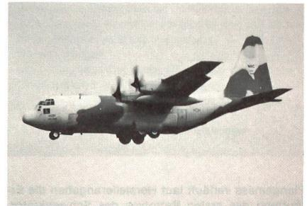
siert –, wird mit leistungsfähigeren Allison T56 Series IV-Motoren ausgerüstet werden. Die neueste «Hercules»-Version soll bei der US-Luftwaffe die 194 Maschinen vom Typ C-130E, die seit Mitte der 60er Jahre im Einsatz stehen, ablösen.
