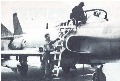
Andrea Lareida von der Sektion Avionik und Lenk- waffen vor dem Einstieg in den Lanser. Das Flugzeug J 32 B Lanser mit einer Spannweite von 13 m, Länge 14,5 m, Höhe 4,65 m, max Startgewicht (4 elektroni- schen Störbehältern) von ca 13 t, Maximalgeschwin- digkeit Mach 1.0, max Belastung +5-3 g. Die Maschi- ne verfügt in der «Stör-Version» zZt über 8 verschie- dene Störgeräte.
