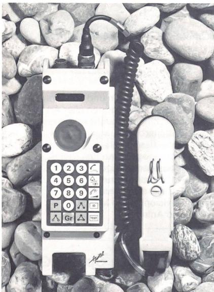
nen. Dank der induktiven Ankopplung können diese rasch und ohne Verletzung der Isolation an jeder beliebigen Stelle an das robuste Feldkabel angeschlossen werden. Diese patentierte Ankopplungsart ermöglicht es, dass derselbe Draht immer wieder verwendet werden kann.
