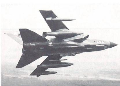
Update-Programms für den GR.1 IDS (Bild oben) zur GR.4-Konfiguration vorgesehenen Systemanpassungen. Dazu gehören ua eine digitale Rollkarte, ein Vorwärtssichtinfrarotsensor, eine neue, multifunktionale Darstellungseinheit sowie ein der zukünftigen Bedrohung angepasstes Selbstschutzsystem.
