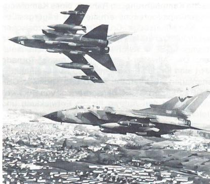
timierte Tornado 2000 erhält eine Rumpfspitze mit einem kleineren Radarquerschnitt, eine längere Zelle für die Aufnahme von zusätzlichem Treibstoff sowie eine neue Generation von Abstandswaffen für die Zerstörung hochwertiger, gut flugabwehrgeschützter Bodenziele. Beibehalten wird der aus zwei Mantelstromturbinen RB.199 bestehende Antrieb sowie die meisten der im Rahmen des geplanten Midlife-
