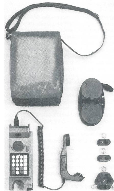
Ein AWITEL-Teilnehmergerät mit induktiver Koppereinheit, Tragtasche, Abschlusswiderständen und Abzweigstück.
