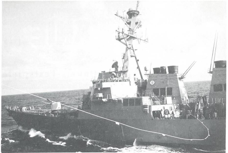
Der neue Raketenzerstörer «*USS Arleigh Burke*» wird unterwegs in der Adria mit Treibstoff vom Flugzeugträger «*USS Theodore Roosevelt*» versorgt. Der neueste atomgetriebene Träger ist in der Lage, Tausende von Tonnen Öl für seine Begleitschiffe mitzuführen.
