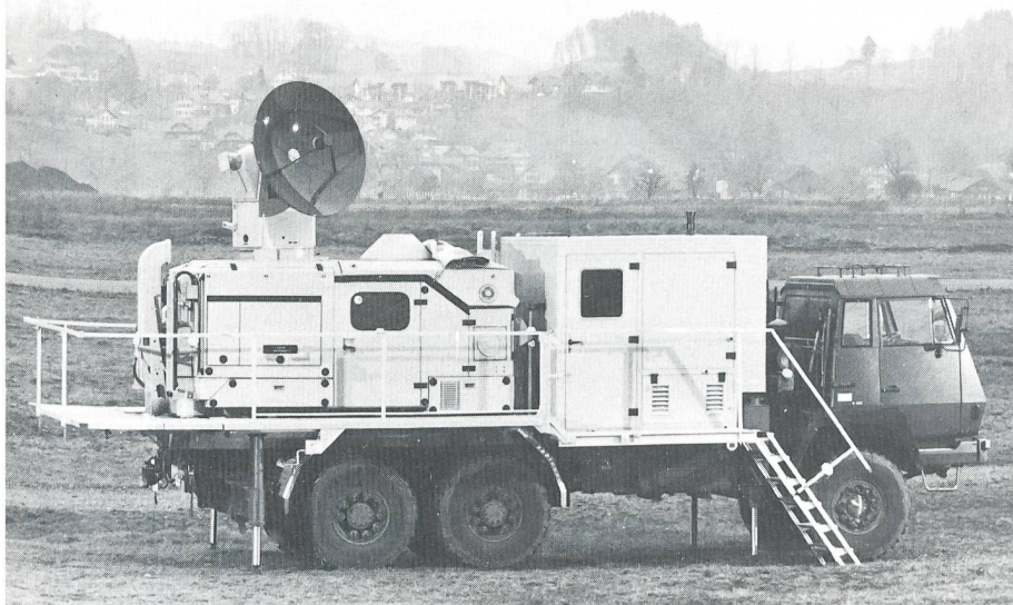
Mit dem seit 1993 im Einsatz stehenden IRIS-Flugbahnvermessungsradar können Geschosse bis über 40 km automatisch verfolgt und eingemessen werden.
