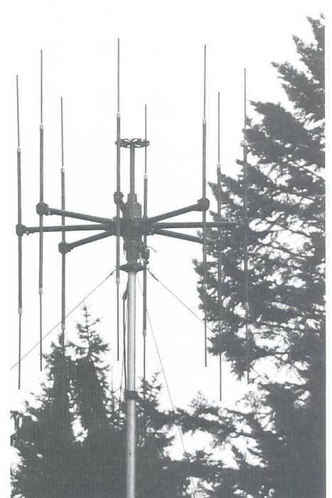
Antennenkopf mit Dipolen des Peilers P-725/m
