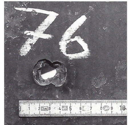
Einwandfreier Durchschuss in Panzerplatte.
