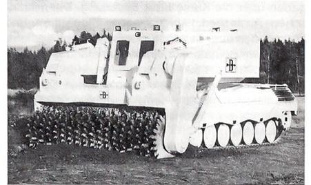
und Swedisch Demining sowie von Tonstad Maskinfabrik AS aus Norwegen. Das Fahrzeug basiert auf einem Leopard-1-Fahrgestell, an das ein Roller integriert wurde. Während der Vorführung wurden im ersten Durchgang 10 von 12 Schützenminen unschädlich gemacht. Nach diesem Erfolg in dem frühen Stadium der Entwicklung sind die beteiligten Firmen überzeugt, die von den UN geforderte Räumbarkeit von 99,6% zu erreichen.
