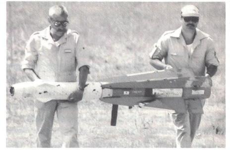
Der mit AHEAD-Munition beschossene Raketenkörper wird von Operateuren der OC zur Gästetribüne gebracht. Die Einschüsse sind deutlich sichtbar.
