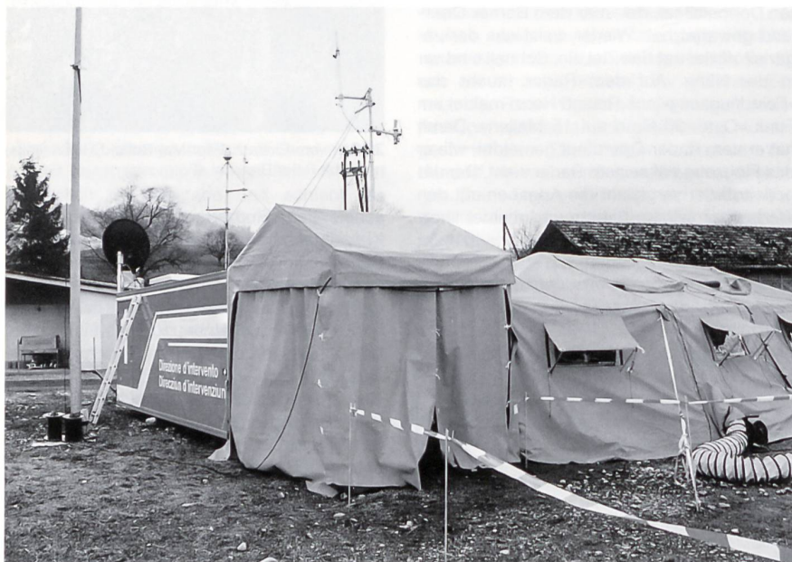
Führungscontainer mit angebautem Führungszelt, welches der Einsatzleitung als Führungsraum dienen kann.
