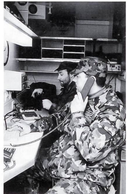
Blick auf den Funkerarbeitsplatz im Führungscontainer; neben dem militärischen Funk stehen alle zivilen Kommunikationsmittel zur Verfügung: Feuerwehrfunk, Polizeifunk, REGA-Funk, ziviles Telefonnetz, Fax, Satelliten-Telefon usw. ✚
