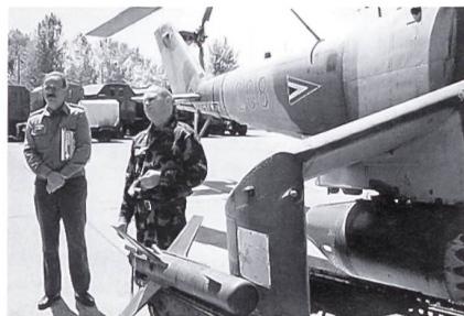
Hpt István Megtért erklärt die Bewaffung des Kampfheli Mi-24. Auf dem Bild das bis 4 km gelenkte Pzaw-Rak-System. Es können 20 Art-Rak abgeschossen werden. Das schwere MG ist vierläufig.
