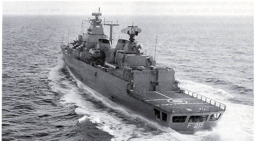
Eine Heckansicht der «Brandenburg». Gut erkennbar sind das Flugdeck und die beiden Hangars für die U-Bootabwehr-Helikopter SEA LYNX Mk 88. Der gespaltene Schornstein reduziert die Ortungsgefahr, weil die heissen Abgase der Gasturbinen verteilt werden.
