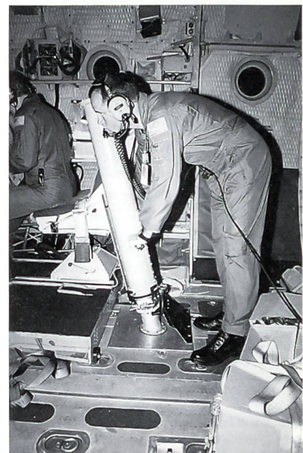
Dropsonden-Operator TSgt Scott Persinger beim Ausstoss einer Dropsonde.
