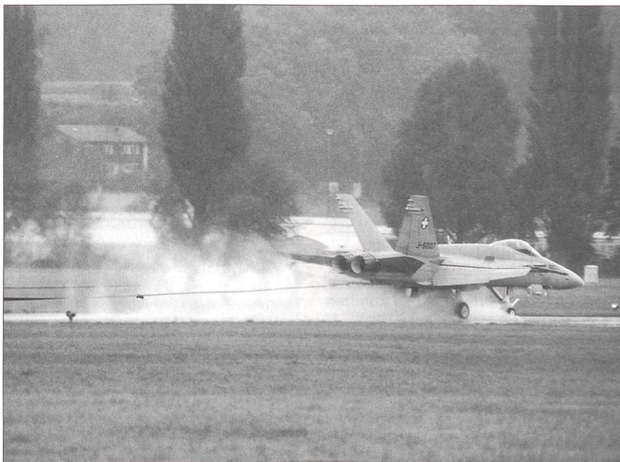
Die F/A-18C J-5007 demonstrierte eine Hakenlandung bei der in Dübendorf neu installierten Kabelfanganlage.
