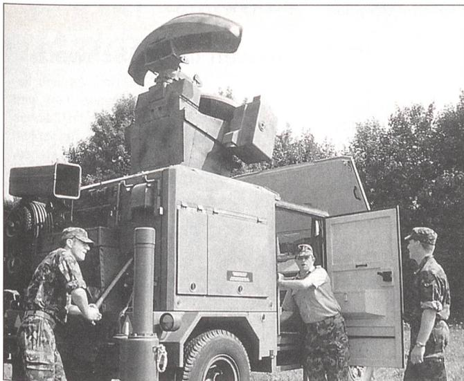
**Übungshalber von Hand. Das Feuerleitgerät Flt Gt 75/95 der Oerlikon-Contraves wird eingerichtet. Durch Pumpbewegungen wird das Richtgerät in Arbeitsstellung gebracht. Adj Uof Erwin Süsslü aus Uster gibt entsprechende Anweisungen.**
