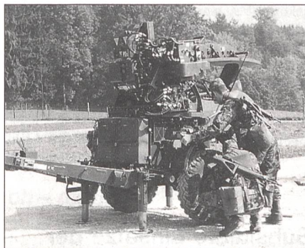
Die Rapiersoldaten der Flab RS I/250 98 beim Aufstellen des Folgeradars.
